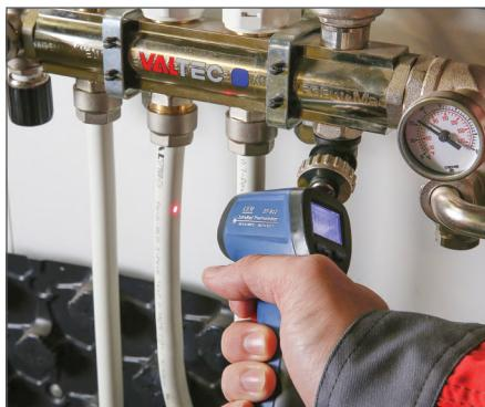
**Рис. 4.1.5.** Измерение температуры труб пирометром
