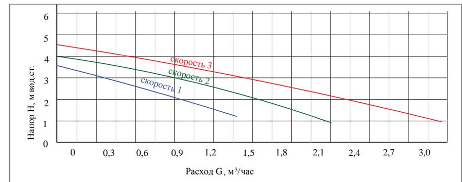
**Рис. 4.4.1. Рабочий график насоса VT.VRS25/4**
