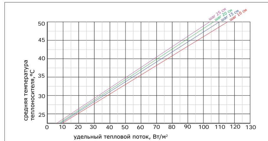
**Рис. 6.5.7.** Зависимость теплового потока от средней температуры теплоносителя (стяжка 70 мм; ковровин; труба 16x2,0)
