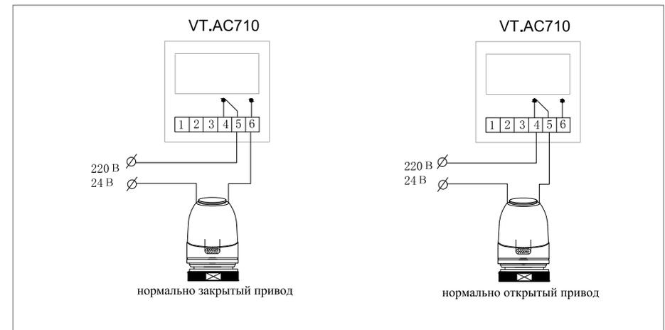
Рис. 5.2.4.2. Схема подключения хронотермостата VT.AC710
