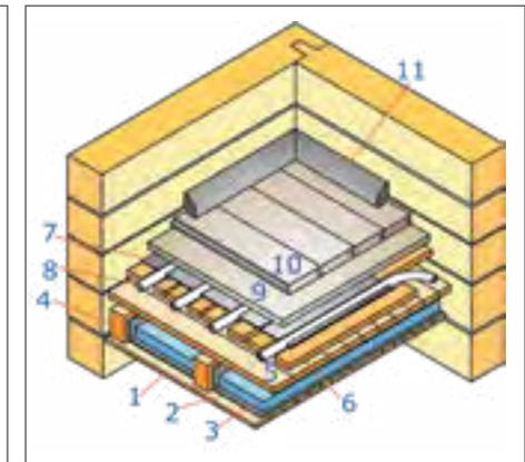
Рис. 2.1.2. Конструкция «сухого» тёплого пола (пример)
