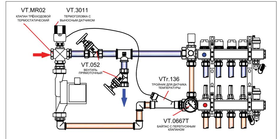
Рис. 4.6.3. Узел на базе трехходового смесительного клапана VT.MR02 под управлением термоголовки VT.3011
