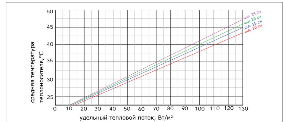
**Рис. 6.5.3. Зависимость теплового потока от средней температуры теплоносителя (стяжка 50 мм; керамическая плитка; труба 16x2,0)**
