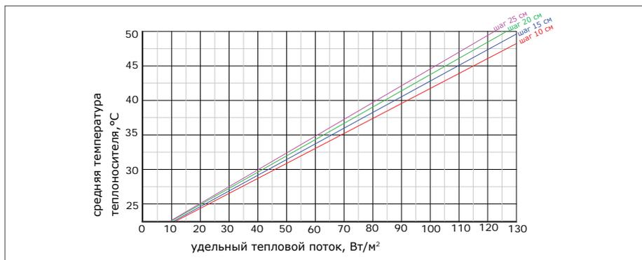
**Рис. 6.5.5.** Зависимость теплового потока от средней температуры теплоносителя (стяжка 30 мм; ковровин; труба 16x2,0)
