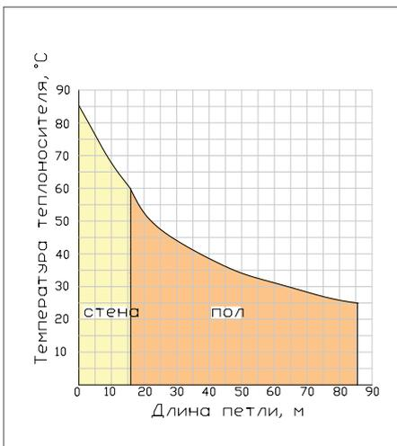
Рис. 3.5.1.4. График остывания теплоносителя для примера на рис. 3.5.1.3
