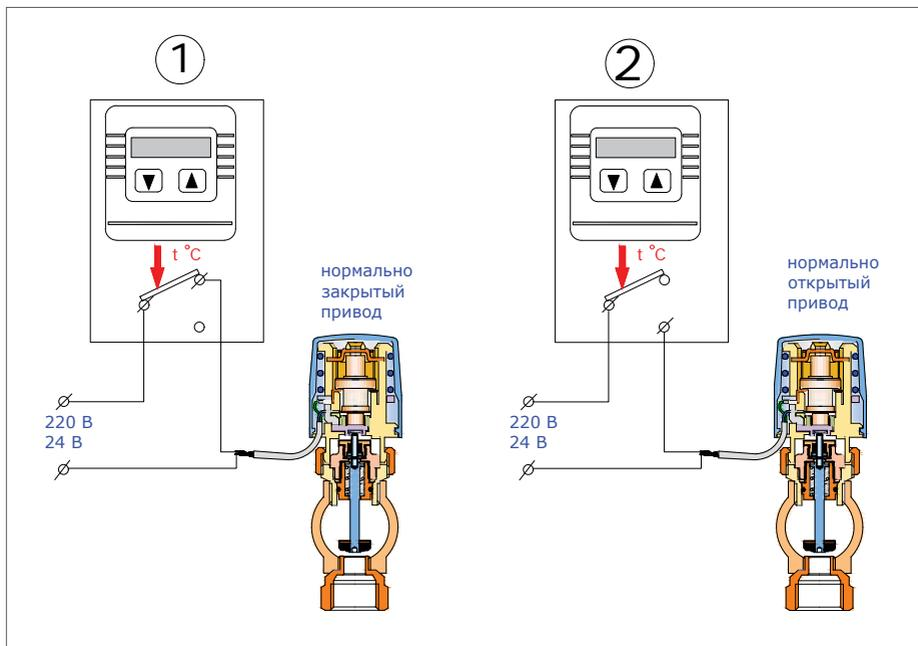
**Рис. 5.2.1.** Принцип работы комнатного термостата и сервопривода
