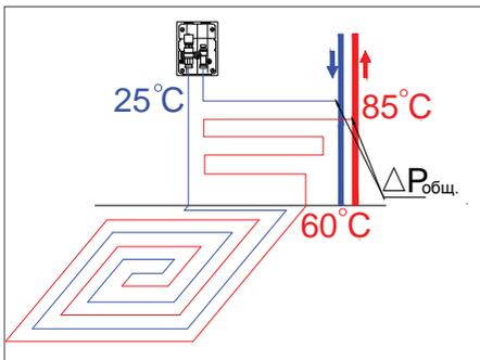
Рис. 3.5.1.3. Установка модулей в систему с температурой теплоносителя свыше 60 °С
