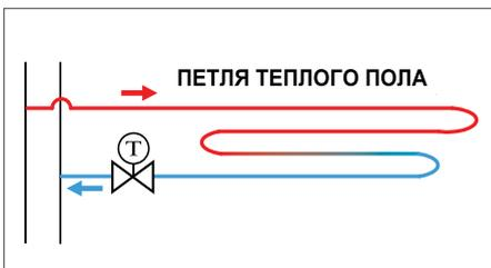
**Рис.3.5.2.2. Схема установки клапана RTL на петле тёплого пола**
