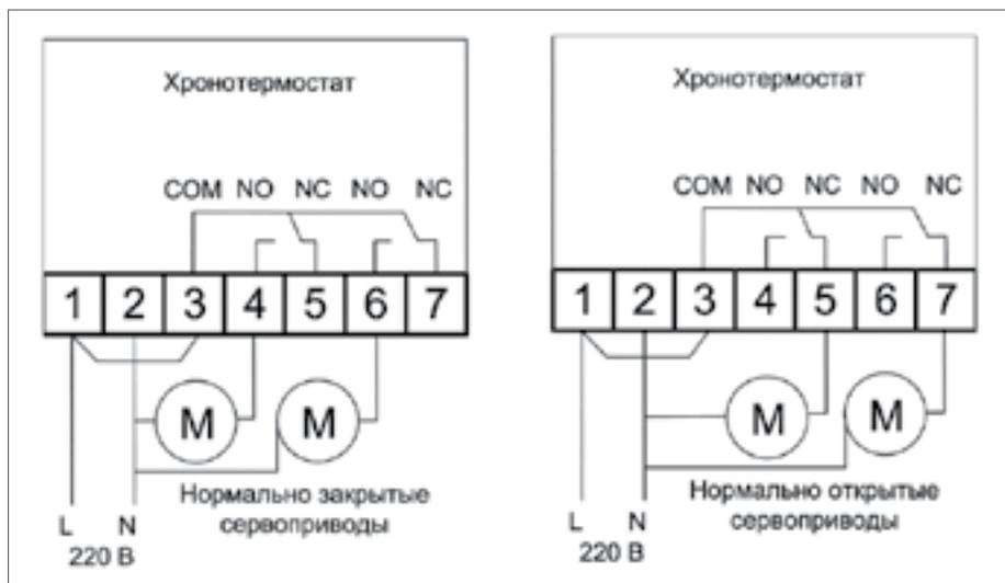
Рис. 5.2.6.3. Схемы подключения хронотермостата VT.AC711
