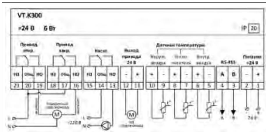
**Рис.5.5.4. Схема электроподключений контроллера VT.K300**
