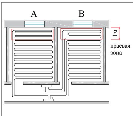
**Рис. 2.4.1. Варианты устройства краевых зон тёплого пола**
