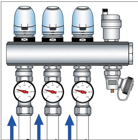
**Рис. 4.1.4.** Тройники с термометрами VT.4615 на обратном коллекторе
