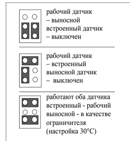
**Рис. 5.2.1.2.** Схема переключения датчиков
