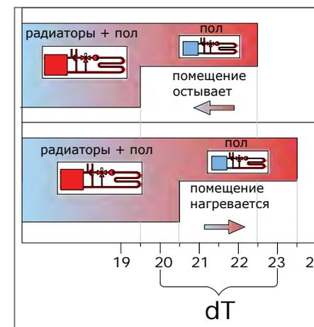
Рис. 5.2.6.2. Схема работы хронотермостата VT.AC711
