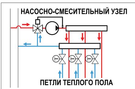
**Рис. 3.5.2.3 Балансировка петель тёплого пола с помощью RTL**
