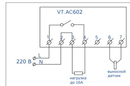
**Рис. 5.2.1.3.** Схема подключения термостата VT.AC602
