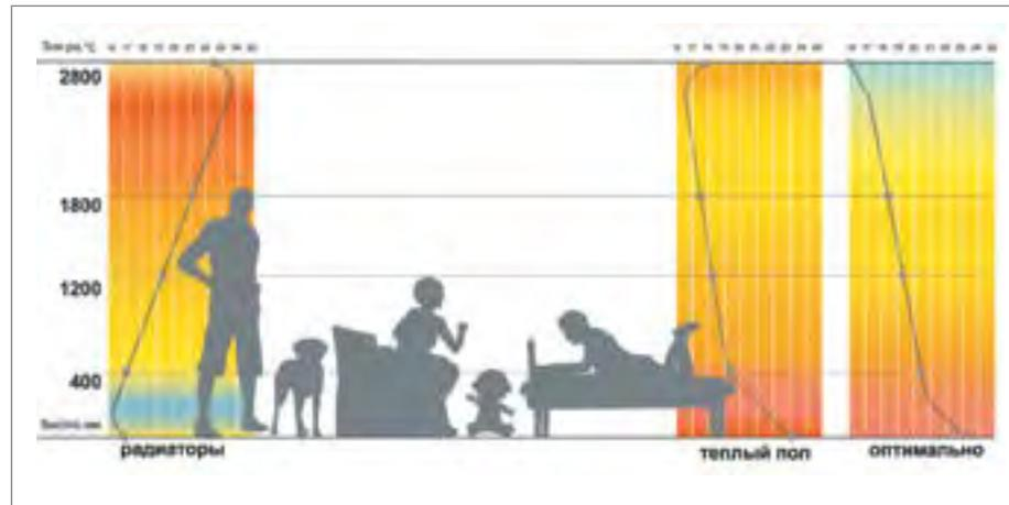
Рис. 1.1.1. Графики распределения температуры по высоте помещения
