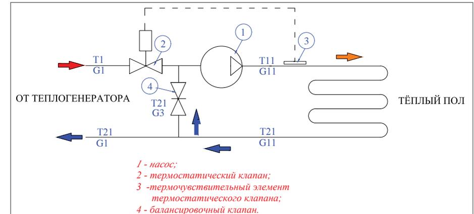
**Рис. 3.4.1. Тепломеханическая схема простейшего насосно-смесительного узла**
