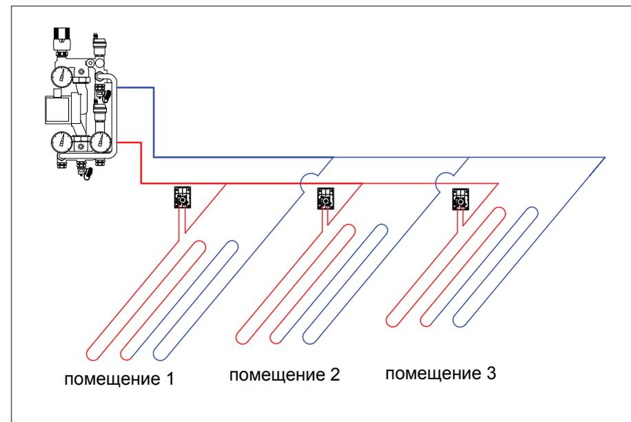
Рис. 3.5.1.6. Пример использования модулей VT.ICBOX.4 и VT.ICBOX.5
