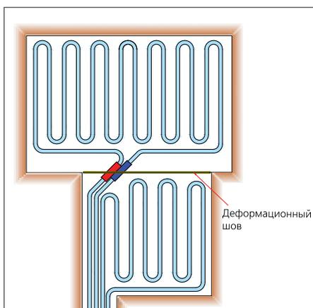
Рис. 2.11.1. Деформационный шов в помещении с входящими углами
