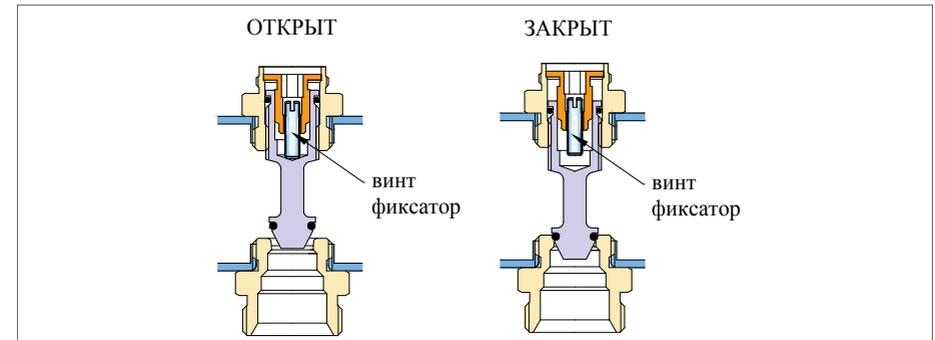
**Рис. 4.1.6.** Фиксация настроечного положения балансировочного клапана
