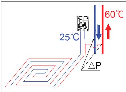
Рис. 3.5.1.2. Установка модулей в систему с температурой теплоносителя 60 °С
