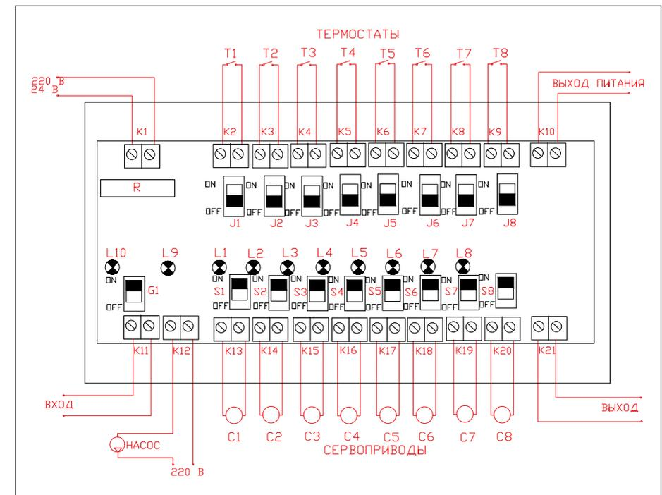
**Рис. 5.3.3. Пример схемы подключения коммуникатора VT.ZC8**
