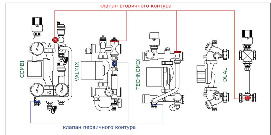
**Рис. 4.2.1.** Расположение балансировочных и запорных клапанов на насосно-смесительных узлах VALTEC
