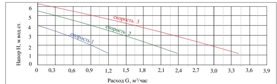
**Рис. 4.4.2. Рабочий график насоса VT.VRS25/6**
