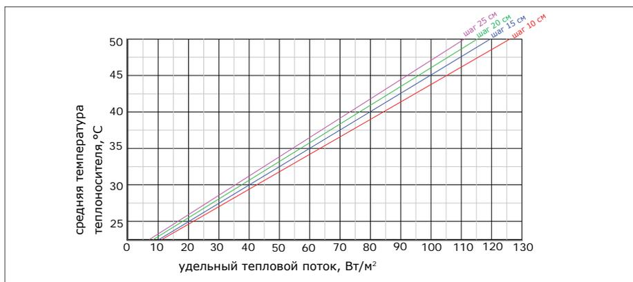
**Рис. 6.5.6.** Зависимость теплового потока от средней температуры теплоносителя (стяжка 50 мм; ковровин; труба 16x2,0)
