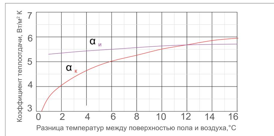
Рис. 1.2.1. Зависимость  $\alpha_u$  и  $\alpha_k$  от  $\Delta t$
