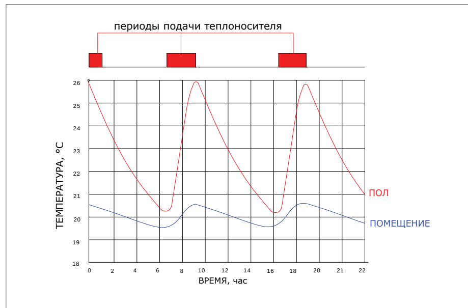
Рис. 5.4.1. График изменения во времени температуры пола и помещения при прерывистом отоплении
