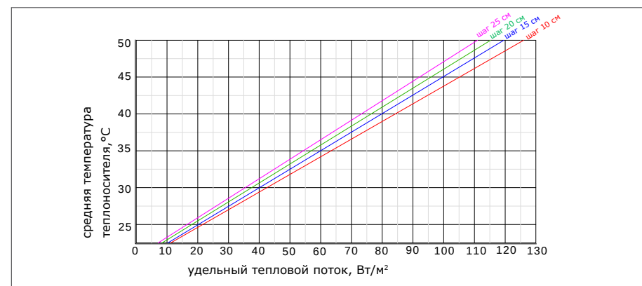
Рис. 6.5.6. Зависимость теплового потока от средней температуры теплоносителя (стяжка 50 мм; ковровый; труба 16x2,0)
