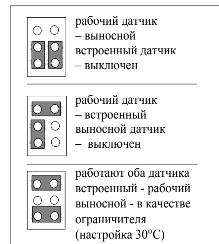
Рис. 5.2.3. Схема переключения датчиков
