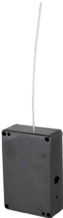
Радиоконцентратор VT.J100 выполняет функции сбора и хранения информации от сети VT.D100 и ее передачи на более высокий уровень системы диспетчеризации. Особенности работы VT.J100:
