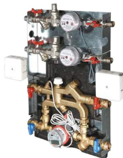
При диспетчеризации по системе Valtec M-Bus квартирная станция оснащается теплосчетчиком VHM-T-B, который имеет два импульсных ввода от водосчетчиков VLF-I и единый выход по протоколу M-Bus (см. рис. 20).
