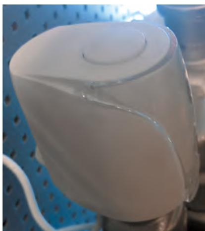
Рис.15 Сервопривод в закрытом положении
