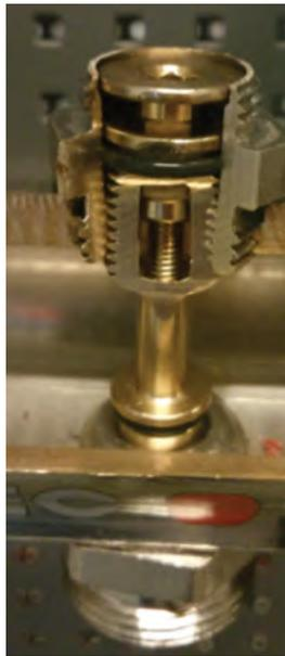
**Рис.12 Настроечный клапан открыт до упора в фиксирующий винт**
