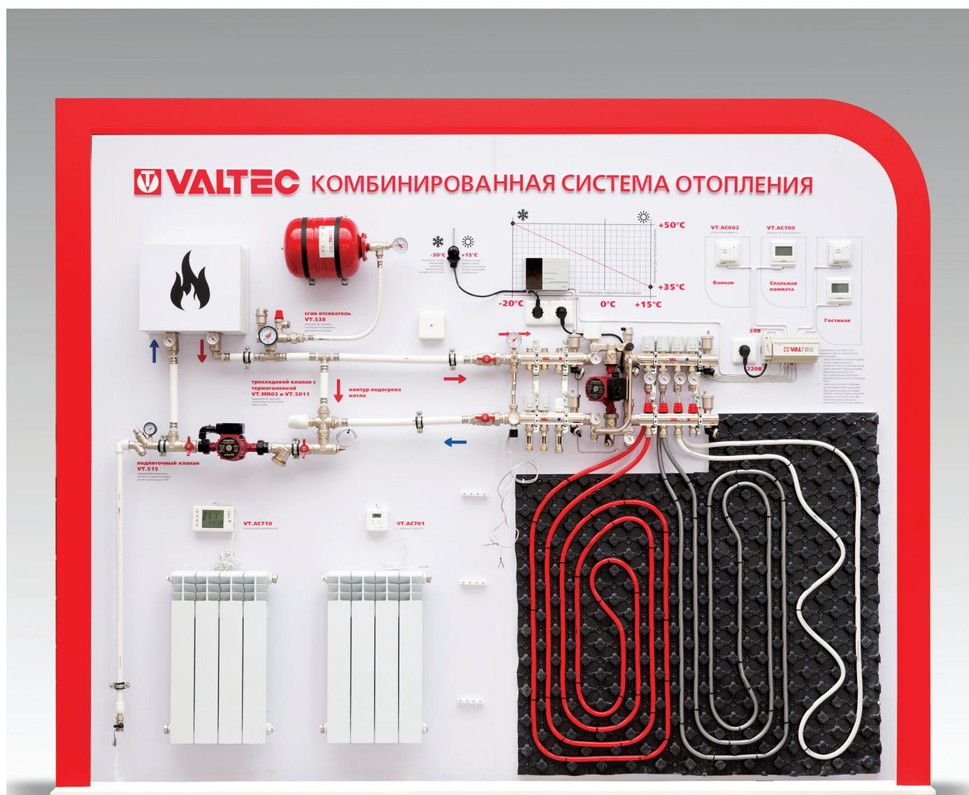
На стенде смонтирован действующий макет комбинированной системы отопления коттеджа.
