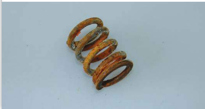
Рис. 5 Пружина регулятора после нескольких лет эксплуатации
