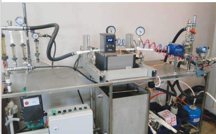
рис.4 Стендовые испытания клапана VT.032 на пропускную способность по ГОСТ 30815-2002
