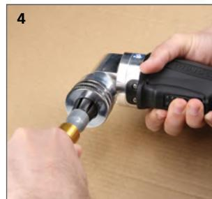
◆ нажмите кнопку пуска. Произойдёт однократное расширение трубы, после чего инструмент автоматически вернётся в первоначальное положение.
