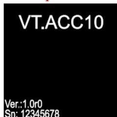
9.1.1. При первоначальной подаче электропитания на привод на экране появится версия программного обеспечения.
