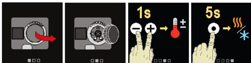
9.5. Переход в режим ручного управления осуществляется нажатием кнопки 8. Настройка нужного положения производится с помощью регулировочного диска 9. Для отключения режима ручного управления следует повторно нажать кнопку 8.
