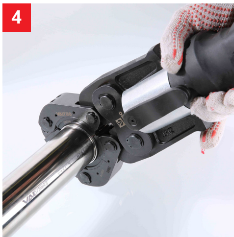
4 Опресовываем фитинг инструментом.
