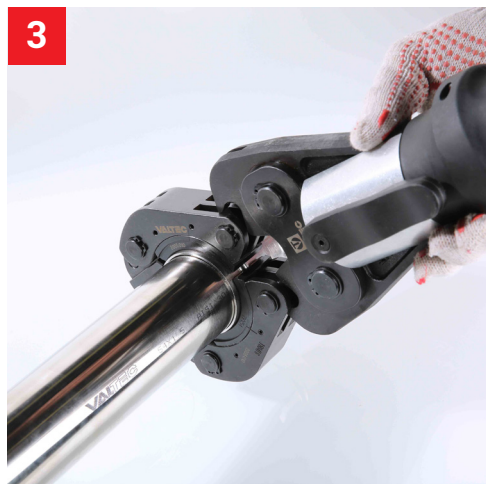
3 Фиксируем пресс-адаптер на кольце, вставляя его в специальный паз.
