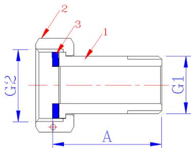
Корпус 1 и накидная гайка 2 сгона выполнены из латуни марки CW 617N по стандарту EN 12165 (соответствует марке LC59-3 по ГОСТ 15527) с гальванопокрытием из никеля.
