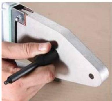
4.2.2. На греющую поверхность сварочного аппарата надеваются ремонтные насадки и закрепляются с помощью винтовой шпильки.
