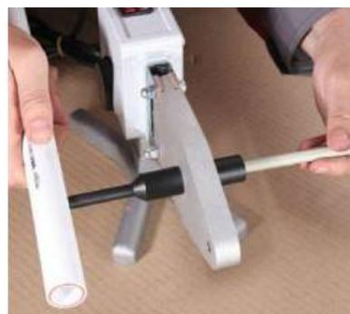
4.2.3. Сварочный аппарат разогревается до требуемой температуры (260°C).
