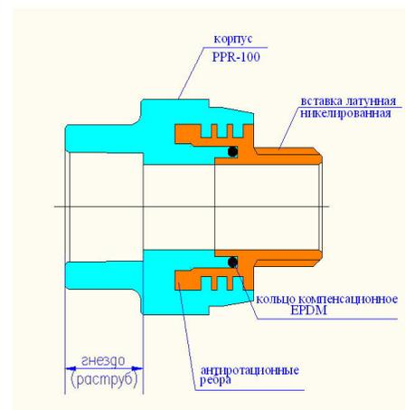
2.1. Комбинированные фитинги включают в себя корпус из полипропилена и латунную никелированную резьбовую вставку круглого сечения с поперечными ребрами, увеличивающими поверхность сцепления и продольными торцевыми ребрами, воспринимающими вращающий момент.
