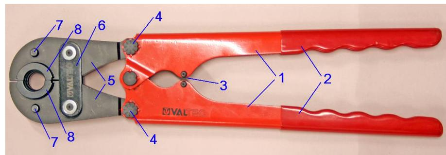
Монтажное усилие, приложенное к рукояткам (1) по принципу рычага передается на полуобоймы (5), в которых закрепляются пресс-вкладыши (8). Вкладыши фиксируются кнопочными фиксаторами (7). Планка (6) стягивает
