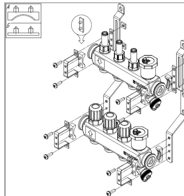
6.6. Коллектор может крепиться к кронштейну как прямоугольной частью, так и круглой частью. Для крепления
