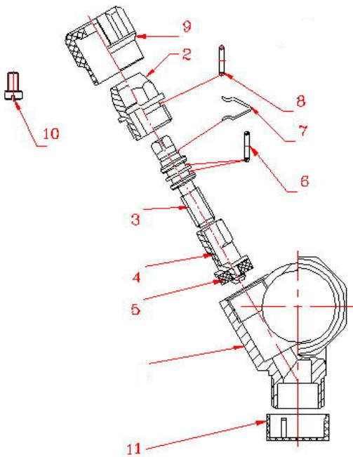
Коллекторы состоят из латунного (CW617N) корпуса 1 с гальванопокрытием из никеля, имеющего на концах присоединительную резьбу (с одной стороны внутреннюю, с другой наружную) и встроенных в корпус регулирующих клапанов. Вращение латунного (CW614N) штока 3 приводит к линейному перемещению ползуна золотника 4 со сменной золотниковой прокладкой из EPDM 5, которая крепится к штоку винтом.
