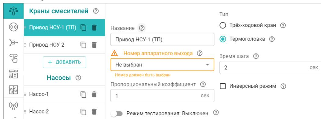
Управление двухпозиционным электротермическим приводом (тип – «**Термоголовка**») – осуществляется за счет подачи импульсов питания с настраиваемой длительностью и периодом их повторений на привод. Для управления таким приводом используется один выход контроллера на 24 В.
