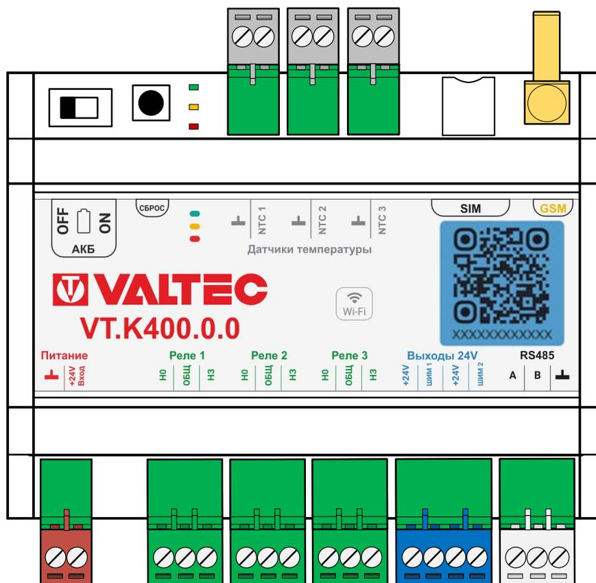
5.5.2. В нижнем ряду располагаются клеммы ввода питания контроллера (=24 В), выходы типа «сухой контакт» трех электромагнитных реле с переключающимся контактом, 2 выхода =24 В для подключения двухпозиционных электротермических сервоприводов, а также порт расширения RS-485 для реализации возможности подключения блока расширения.
