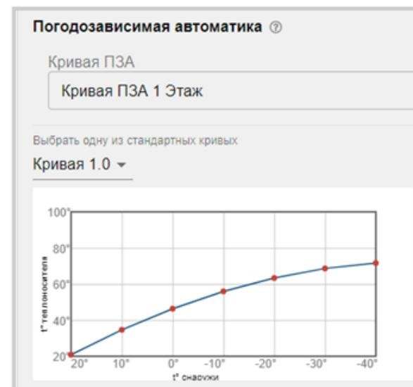
Существует возможность изменения целевой температуры для контура— это приведет к сдвигу выбранной через кривой отопления. Например, если в помещении нужно поддерживать 23 °С – необходимо сдвинуть кривую относительно изначального графика вверх, если необходима целевая температура воздуха 17 °С – кривую нужно сдвинуть вниз. Вид графиков со сдвигом представлен на рисунке ниже.
