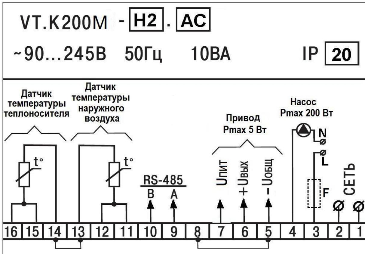
5.3.9. Подключение сервопривода **VT.TE 3061** осуществляется в следующем порядке: клемма 7 –чёрный провод; клемма 6 –красный провод; клемма 5 – синий провод.
