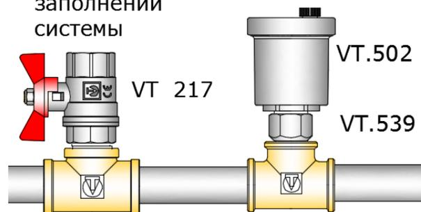
7.5. Рабочая среда не должна способствовать образованию накипи и шлама на внутренних поверхностях клапана, а также вымыванию цинка из латуни. Карбонатный индекс горячей воды, проходящей через клапан, не должен превышать 1,5 (мг-экв./дм<sup>3</sup>)<sup>2</sup>. Индекс Ланжелье для воды должен быть больше 0.
