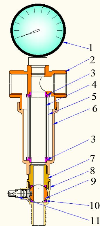
Фильтр состоит из корпуса 2 и колбы 6, выполненных из горячештампованной латуни CW617N с гальваническим покрытием из никеля. Между собой корпус и колба соединены на резьбе с кольцевой прокладкой из EPDM.
