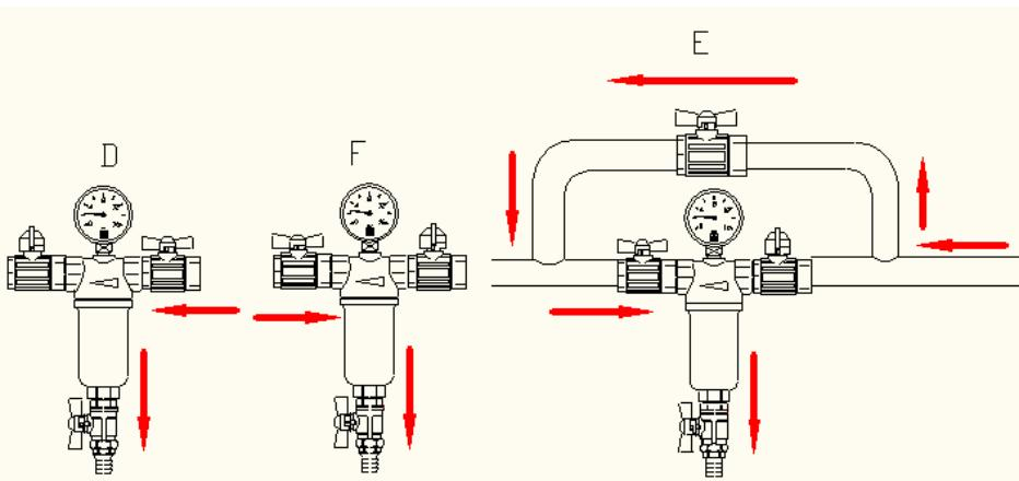
А) Перекрыть выходной кран. Открыть сливной кран и слить осадок в канализацию вместе с каким-то количеством сетевой
