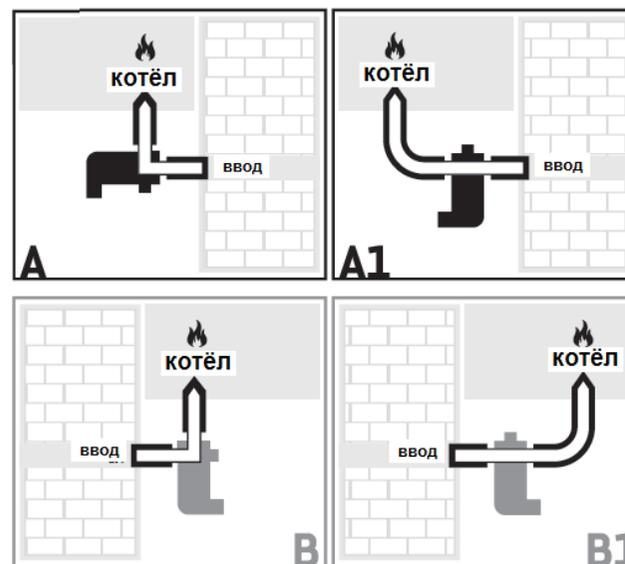
2.2 Фильтр может подключаться к системе 4-мя различными способами (см.рис), при этом колба фильтра с дренажным краном всегда будет расположена внизу, что не позволит осадку проникнуть обратно в подающий трубопровод. При подключении по вариантам В и В1 требуется развернуть поворотную вставку фильтра на 180°.
