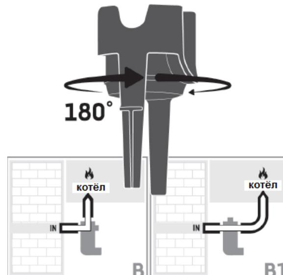
Положение вставки можно определить по расположению выступов на вставке и на корпусе. Положение, показанное на рисунке, соответствует схеме подключения А.
