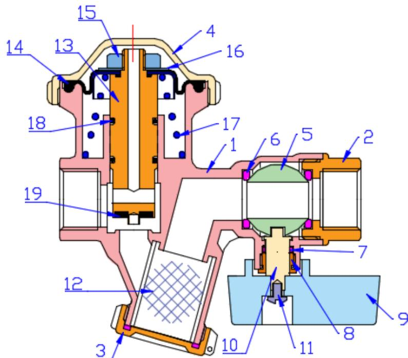
Корпус крана с фильтром и регулятором давления состоит из большого полукорпуса 1, малого полукорпуса 2, заглушки 3 и крышки 4. В зоне шарового крана расположен шаровой затвор 5. Герметичность шарового затвора обеспечивают два седельных уплотнительных кольца 6.
