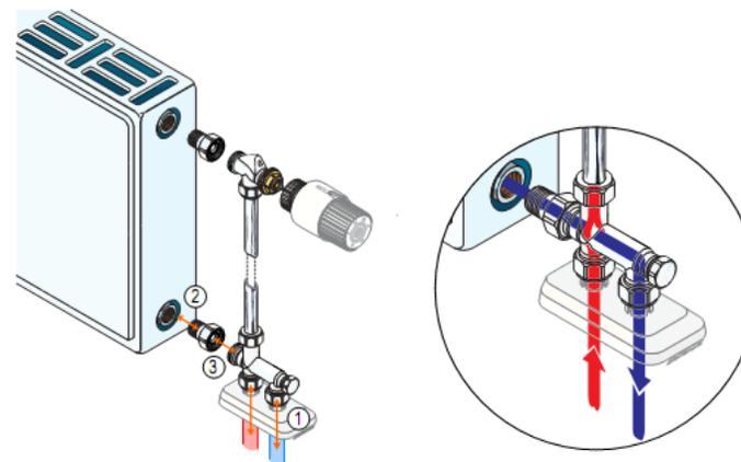
6.2. При использовании термоголовки или сервопривода, колпачок ручной регулировки регулирующего клапана должен быть снят.
