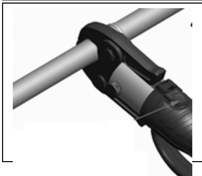
6.8. Нажмите кнопку пуска и выполните соединения. В случае ошибки, нажмите кнопку ручного возврата и вручную верните поршень в исходное положение
