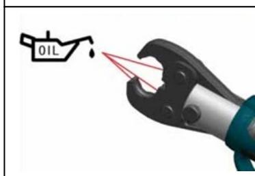
6.10. После завершения работы с инструментом капните каплю машинного масла на ролики штока.
