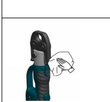
6.11. Перед укладкой в чемодан протрите инструмент сухой ветошью.
