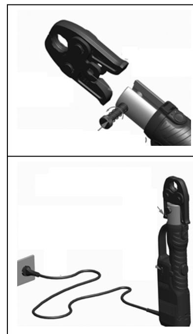
6.4. Нажмите и поверните стопорный палец 2, при этом за счет пружины он выдвинется. Вставьте пресс-насадку, нажмите и поверните стопорный палец.
