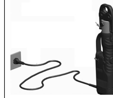
6.4. Нажмите и поверните стопорный палец 2, при этом за счет пружины он выдвинется. Вставьте пресс-насадку, нажмите и поверните стопорный палец.
