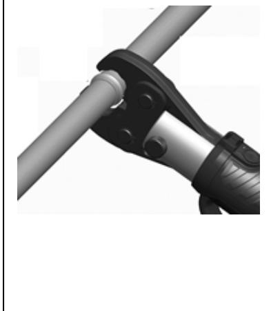
6.7. Для выполнения пресс-соединения установите пресс-насадку на фитинг так, чтобы монтажный буртик фитинга совпал с соответствующей канавкой пресс-насадки. Обратите внимание, чтобы не было перекоса между осью инструмента и осью пресс-насадки—это может привести к опасным повреждениям
