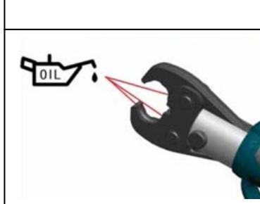
6.10. После завершения работы с инструментом капните каплю машинного масла на ролики штока.
