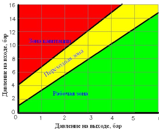
4.3. **Границное условие 2:** соотношение давления на входе и на выходе регулятора должно быть таким, чтобы попадать в рабочую или переходную зону графика кавитации. В случае нарушения этого условия седло регулятора будет подвергаться кавитационному разрушению.
