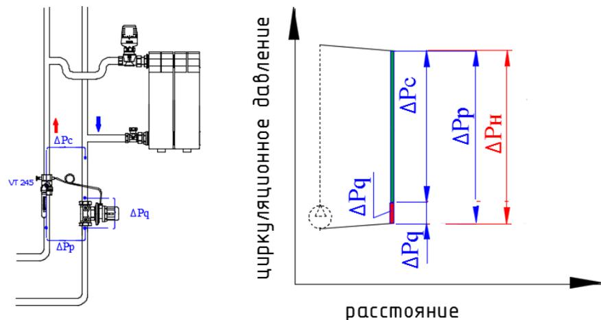
Импульсная трубка подключается к шаровому крану VT.245, установленному на подающем стояке. Схема применяется для крайних стояков систем.
