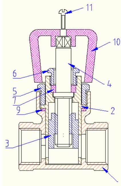
Внутри корпуса 1 расположена цилиндрическая пробка монтажной настройки 2 с круглым проходным отверстием. Поворотом пробки меняется пропускная способность крана от 0 до 100%. Монтажная настройка может происходить только при ослабленной крышке корпуса 5 (на сухом трубопроводе). Пользовательское регулирование осуществляется с помощью рукоятки 11. При ее вращении происходит перемещение цилиндрического шибера 3. Шток 4 с червячной передачей уплотнен с помощью сальника 7 и сальниковой гайки 6.
