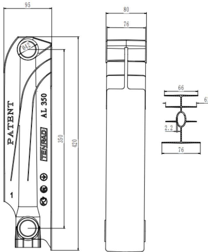
3.1. Секции радиатора выполнены из высокопрочного алюминиевого сплава ADC12 по норме JIS H5302 методом литья под давлением.
