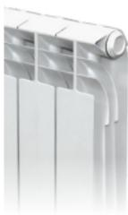
**3.1.** Секции радиатора выполнены из высокопрочного алюминиевого сплава ADC12 по норме JIS H5302 (примерно соответствует российской марке АК12М2 по ГОСТ 1583-93) методом литья под давлением.
