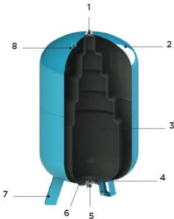
Корпус бака 2 выполнен сварным из углеродистой стали. Внутри корпуса расположена сменная мембрана 3 из этиленпропилен-диен мономера (EPDM), имеющая ступенчато расширяющуюся книзу форму. Материал мембраны допущен к контакту с пищевыми жидкостями. Толщина стенки мембраны увеличивается сверху. Такая конструкция предотвращает возникновение в ней критических растягивающих усилий и предотвращает мембрану от трения о стенки бака. Фартук мембраны закреплен контрфланцем
