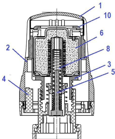
Сильфонная емкость 6, помещенная в пластиковый неподвижный полукорпус 3, заполнена этилацетатом. Расширение жидкости приводит к воздействию сильфона на пластиковый шток 5 с толкателем, подпружиненным пружиной 8. Толкатель 5 воздействует на шток регулирующего клапана. Крышка корпуса 1 закрывает камеру, в которой размещается зубчатое кольцо-
