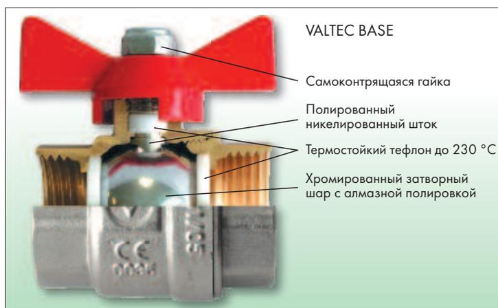
Полировка и гальванопокрытие штока и шара практически исключили их абразивное воздействие на уплотнительные и седельные кольца. Ведь именно мельчайшие бугорки и неровности на затворном шаре способствуют преждевременному выходу из строя седельных уплотнений. В свою очередь полировка затворного шара уменьшила вероятность прилипания к его поверхности
