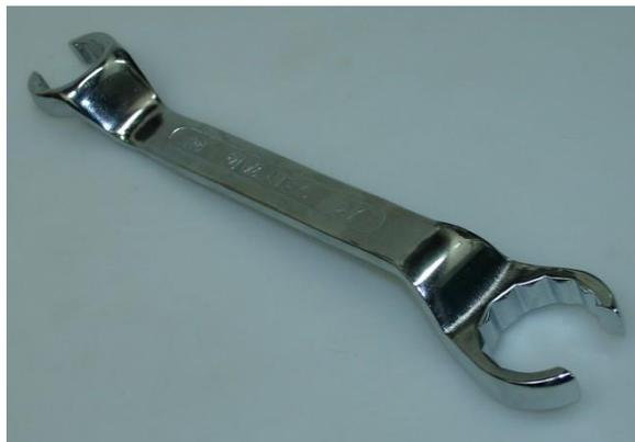
Данный ключ предназначен для соединителей  $\frac{3}{4}$ " , а также  $\frac{1}{2}$ " (24/27)
