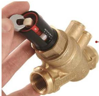
Картридж с открытой настройкой VT.PICV01 устанавливается там, где исключено несанкционированное вмешательство в настройку. Такой картридж регулируется с помощью гаечного ключа и легко перенастраивается на нужный расход по настроечной шкале.
