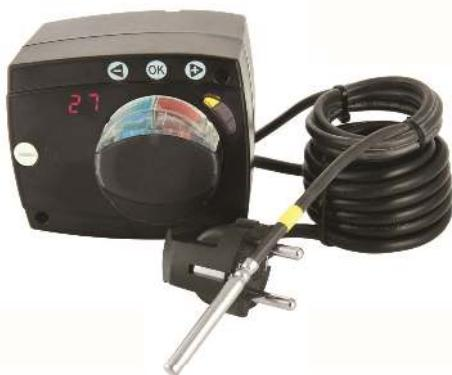
Ротационный сервопривод предназначен для управления трехходовыми и четырехходовыми смесительными клапанами типа VT.MIX03; VT.MIX04, а также смесительными клапанами, входящими в состав модулей быстрого монтажа VT.VAR20 и VT.VAR21 (система VARIMIX). Встроенный в привод контроллер и входящий в комплект датчик температуры теплоносителя делает привод самостоятельным аналоговым терморегулятором, который способен поддерживать температуру теплоносителя на заданном пользователем уровне. До появления
