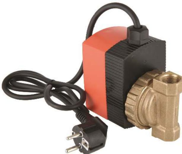
Номенклатура циркуляционных насосов VALTEC пополнилась центробежным циркуляционным насосом с мокрым ротором VT.VSB04-15 . Этот насос состоит из двух модулей: латунного корпуса рабочей камеры с присоединительными патрубками и электромеханического блока, в котором расположен герметичный изолированный ротор с крыльчаткой, статор и плата с присоединительными контактами. Модули соединяются между собой с помощью латунной накидной гайки.
