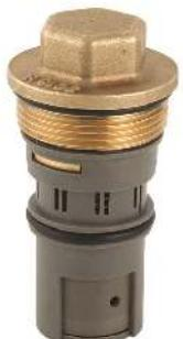
В корпус устанавливаются сменные картриджи, на которых настраивается требуемый расход. Если гидравлика системы меняется (устанавливаются или удаляются радиаторные терморегуляторы; меняется схема системы и т.п.), то достаточно заменить картридж, не снимая с трубопровода сам корпус стабилизатора.
