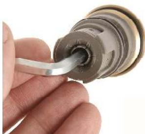
Если пользовательская перенастройка стабилизатора не требуется, то используются картриджи со скрытой настройкой VT.PICV01. Настройка расчетного расхода на таком картриidge осуществляется при помощи шестигранного ключа до установки в корпус. Это позволяет исключить несанкционированный доступ к настройке регулятора и обеспечить стабильную работу системы отопления. Такие картриджи устанавливаются в местах, куда могут получить доступ люди, не относящиеся к обслуживающему персоналу.
