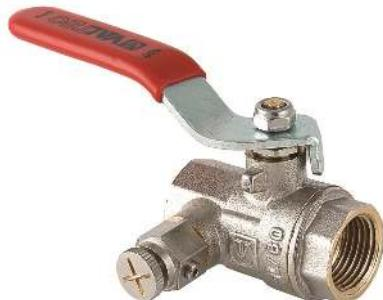
Для удобства обслуживания ручного воздухоотводчика крана VT.245, кроме боковых насечек на головке игольчатого винта сделан крестообразный шлиц. Теперь открывать и закрывать воздухоотводчик можно с помощью шлицевой отвертки, не опасаясь получить ожёг. Изменение внесено по многочисленным пожеланиям монтажников.
