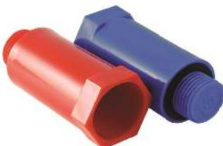
Комплект предназначен для временного перекрытия водорозеток под смесители на период производства отделочных работ. Пробки могут монтироваться как трубным, так и шестигранным ключом. Пробки снабжены уплотнительными кольцами из EPDM, поэтому их установка не требует применения дополнительного уплотнительного материала. В комплект входят две пробки синего и красного цвета. Длина пробки (без резьбовой части) -68 мм.
