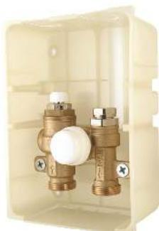
Семейство терморегулирующих монтажных комплектов VALTEC IC BOX пополнилось ещё одним изделием. Напомним, что комплексты IC BOX-1 и IC BOX-2 предназначены для безнасосного подключения водяного теплого пола к первичному отопительному контуру. В состав этих комплектов входит встроенный ограничитель температуры, регулируемый пользователем, а также терmostатический клапана, регулирующий теплоотдачу с помощью терmostатической головки с выносным датчи-
