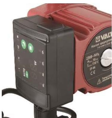
Начиная с декабря 2015 года в электронную схему включения всех циркуляционных насосов VT.VRS включен термистор (термореле), который позволяет автоматически отключать насос в случае перегрева его обмоток. Именно перегрев обмоток является наиболее частой причиной выхода из строя насосов. Перегрев происходит в тех случаях, когда свободное вращение ротора и крыльчатки насоса имеются помехи. Помехи могут быть вызваны:
