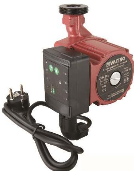
К насосу с частотным регулированием VT.VRS 25/6 EA -180 монтажной длиной 180 мм добавился насос длиной 130 мм. Этот насос может устанавливаться в насосно-смесительные узлы VALTEC DUAL, значительно повышая их энергоэффективность. Напомним, что насосы с частотным регулированием могут работать как в обычном трехскоростном режиме, так и в режимах поддержания постоянного напора и в режиме поддержания пропорционального напора, когда напор повышается пропорционально повышению расхода.
