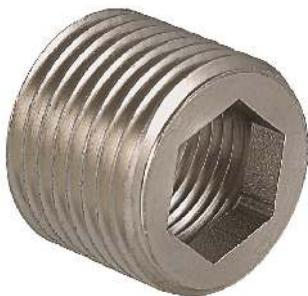
В отличие от обычной футорки, монтаж которой предусмотрен гаечным ключом, у футорки VTr.660 отсутствует монтажный многогранник, который служит для захвата гаечным ключом. Её монтаж производится шестигранным ключом, поэтому на смонтированном трубопроводе эта футорка не видна. Тем самым снижается монтажная длина узла и улучшается его эстетический вид. Футорка, как и остальные фитинги серии VTr, выполнена из горячепрессованной никелированной латуни CW617N методом горячего объемного прессования.
