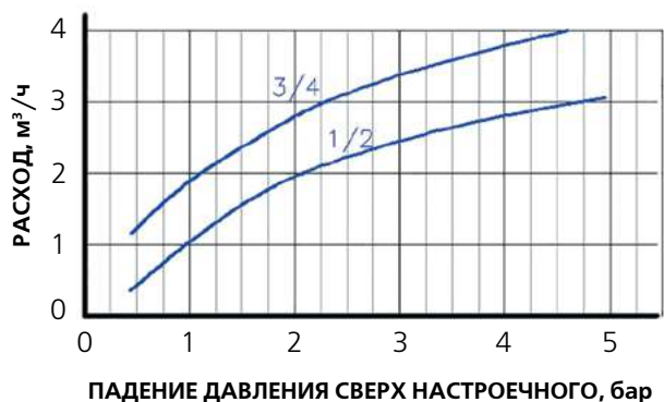
График зависимости потерь давления (сверх настроечного) от расхода
