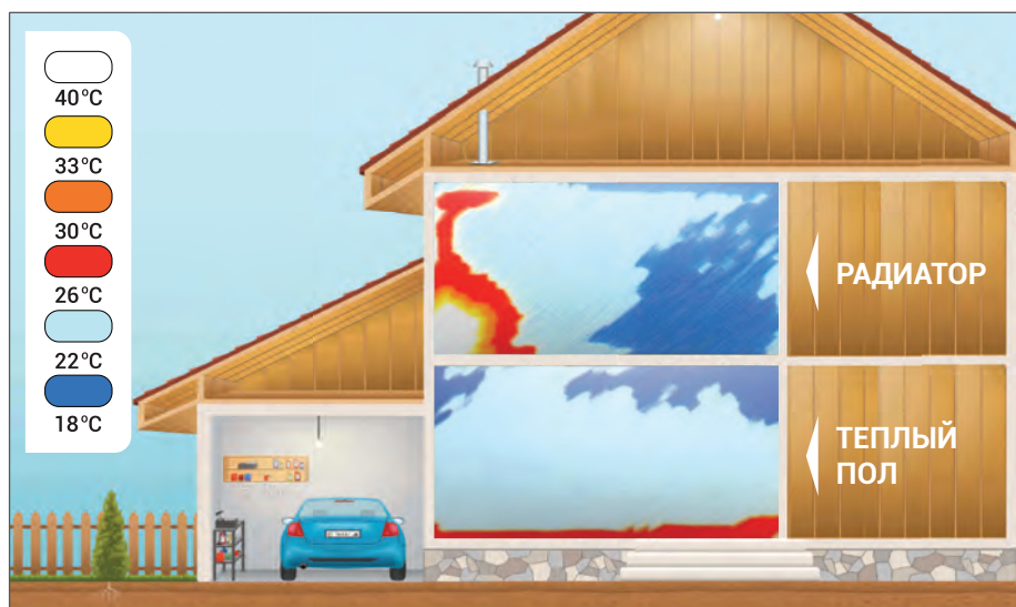
Рис. 2. Распределение тепла в помещении в зависимости от способа отопления
