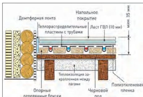
Рис. 4. Деревянная система теплого пола
