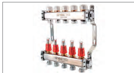
VTc.584.EMNX коллекторный блок из нержавеющей стали AISI 304 с расходомерами, термостатическими клапанами (от 3 до 10 выходов)
