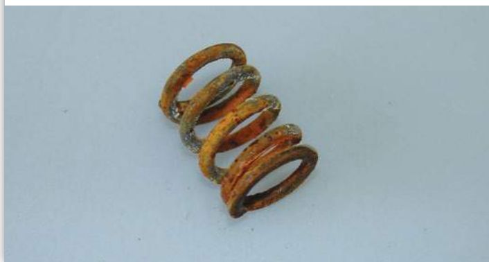
Рис. 5 Пружина регулятора после нескольких лет эксплуатации
