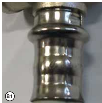
81 При первичной опрессовке на гильзе появляются два параллельных углубления и характерные «защипы» в местах сопряжения пресснасадок
