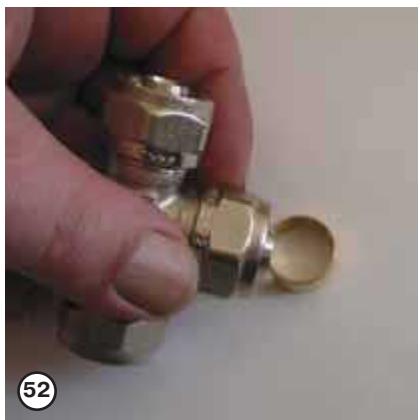
52 Пригодность резьбы проверяется предварительным навинчиванием накидной гайки при снятом «сухаре»
