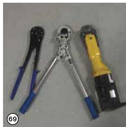
Опрессовка соединителей может производиться ручными или электрическими пресс-клещами
