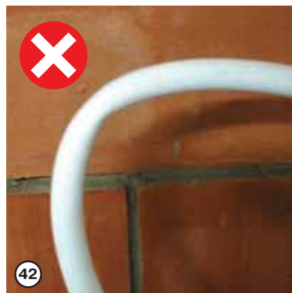
42 Превышение допустимого радиуса изгиба приведет к «залому» трубы, а это, в свою очередь, требует вырезания «заломанного» участка трубы, и замены его новым
