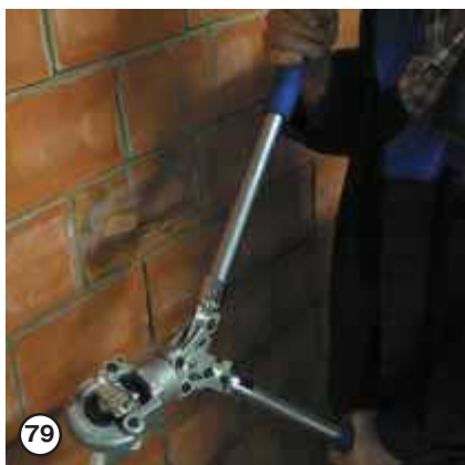
79 Поскольку обойма инструмента имеет шарнирное крепление к рукояткам, то рукоятки можно устанавливать в любое удобное положение
