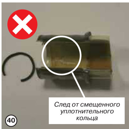
Отсутствие фаски может привести к повреждению уплотнительных колец штуцера, в результате чего при обжиме и опрессовке кольцо теряет проектное положение и служит причиной протечки
