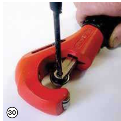
Если ролик роликового трубореза затупился или имеет заусенцы, производится его замена, для чего отверткой с плоским наконечником отвинчивается винт крепления ролика, ролик заменяется на новый и крепится винтом
