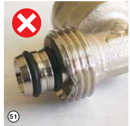
51 При использовании обжимных фитингов необходимо удостовериться в отсутствии внешних повреждений
