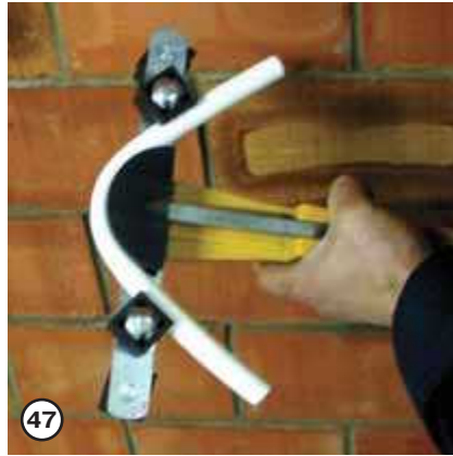
47 Таким трубогибом также удобно пользоваться и для изгибания маломерных отрезков труб меньшего диаметра
