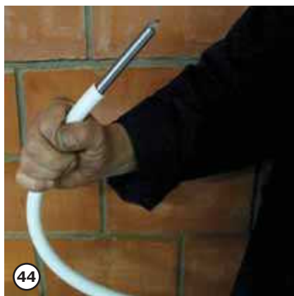
44 Внутренний кондуктор дает максимальную гарантию того, что при радиусе изгиба, равном утроенному наружному диаметру трубы, повреждения трубы не произойдет, однако пользоваться таким кондуктором удобно только при небольших отрезках трубы
