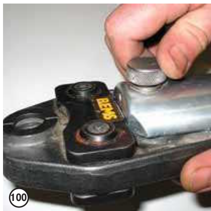
100 Установив пресс-насадку, следует нажать на фиксирующий палец и повернуть стопорную гайку по часовой стрелке
