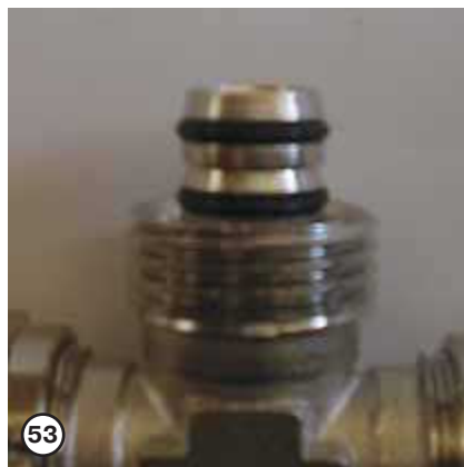
53 Резиновые уплотнительные кольца должны плотно (без бугров) располагаться в предназначенных для них канавках
