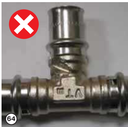
При использовании пресс-соединителей придерживаются следующего порядка: – проверяется пригодность фитинга к монтажу ( фитинг не должен иметь внешних повреждений )
