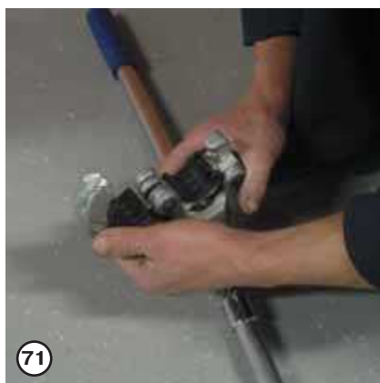
– нажатие на рычаг замка приводит к открыванию пресс-обоймы;
