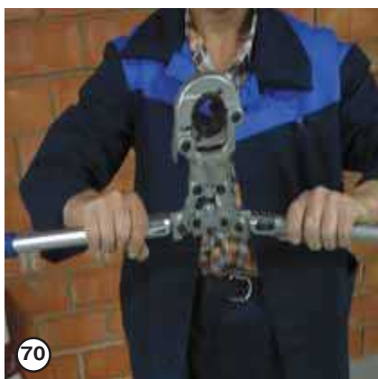
При работе ручными пресс-клещами Valtec придерживаются следующего порядка: – для возможности установки или замены пресс-вкладышей, ручки клещей разводятся на 180°;
