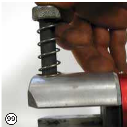
99 При этом подпружиненный фиксирующий палец выдвигается
