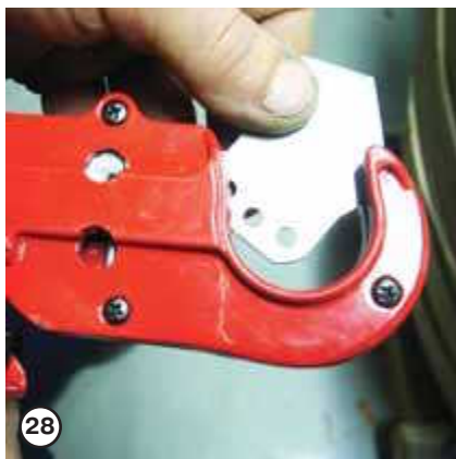
– нож извлекается из корпуса трубореза;
