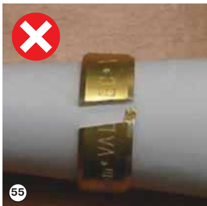
«Сухарь» на разрезе не должен иметь заусенцев
