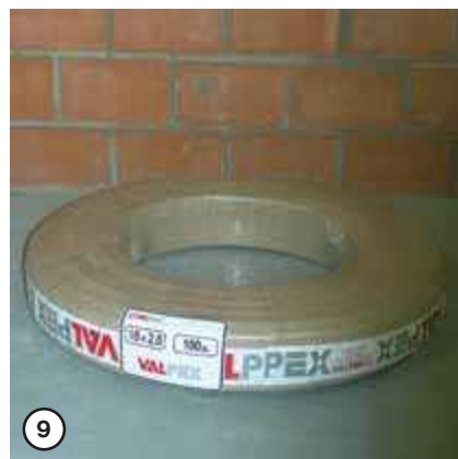
9 Если бухта металлопластиковой трубы доставлена в помещение с мороза, ей дается возможность вылежаться в течение 5 часов при температуре не менее 10°C
