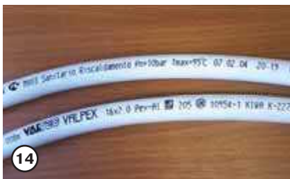
14 Проверяется соответствие указанных на трубе максимально допустимых температуры и давления реальным условиям эксплуатации
