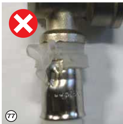
77 Несоблюдение этого правила приводит к порче фитинга, некачественному соединению и поломке инструмента
