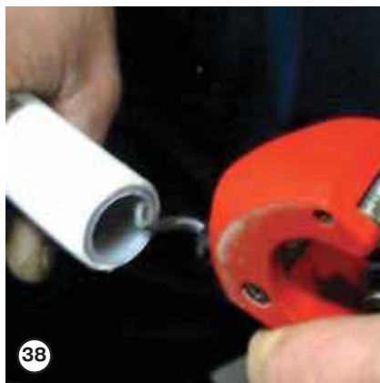
38 Изогнутый нож штыревого фаскоснимателя прислоняется к кромке трубы и им производятся круговые движения
