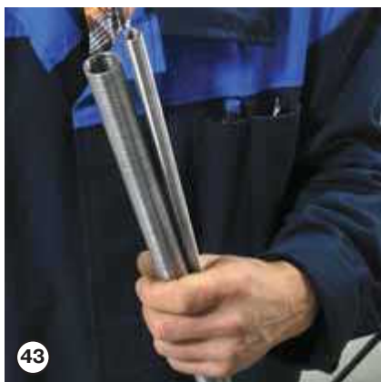
43 При радиусе изгиба трубы менее указанных выше, а также для изгиба трубы диаметром 26, 32 мм необходимо использовать наружный или внутренний кондуктор
