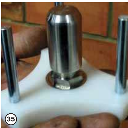
Если используются комбинированные калибраторы, то снятие фаски можно производить одновременно с калиброванием, для чего в основании калибровочных штырей имеются фасочные ножи
