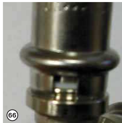
Если фитинг имеет цельную гильзу, в контрольном окошке должна быть видна тефлоновая диэлектрическая шайба
