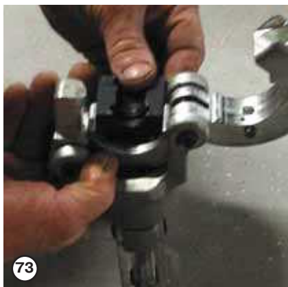
73 – при нажатой кнопке фиксатора в обойму (по направляющим сбоку) вставляется сначала один пресс-вкладыш;
