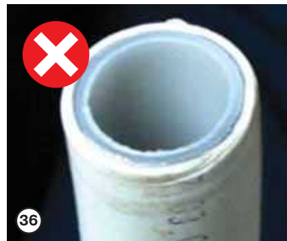
Если труба одета на комбинированный калибратор не до конца, то снятия фаски либо не происходит, либо производится некачественно
