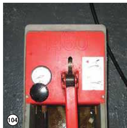
104 Гидравлический пресс присоединяется, как правило, к сливному крану коллектора. Система заполняется водой при давлении, в 1,5 раза превышающем расчетное рабочее избыточное давление
