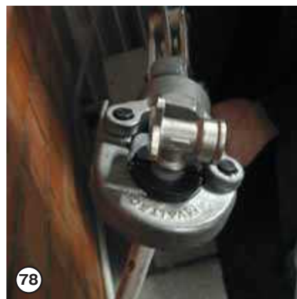
78 После фиксации инструмента обойма закрывается до защелкивания замка
