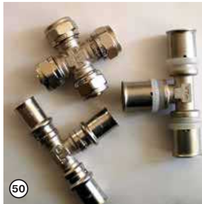
50 Соединения металлопластиковых труб могут выполняться с помощью обжимных или пресс-фитингов. Обжимные соединители не допускаются замуровывать в строительные конструкции
