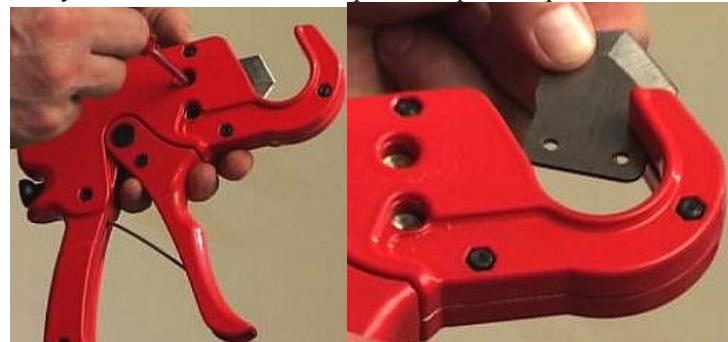
4.5. После проведения 500 резов следует смазать все оси трубореза машинным маслом.
