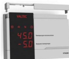
2.- -отсоедините контроллер от монтажной панели
