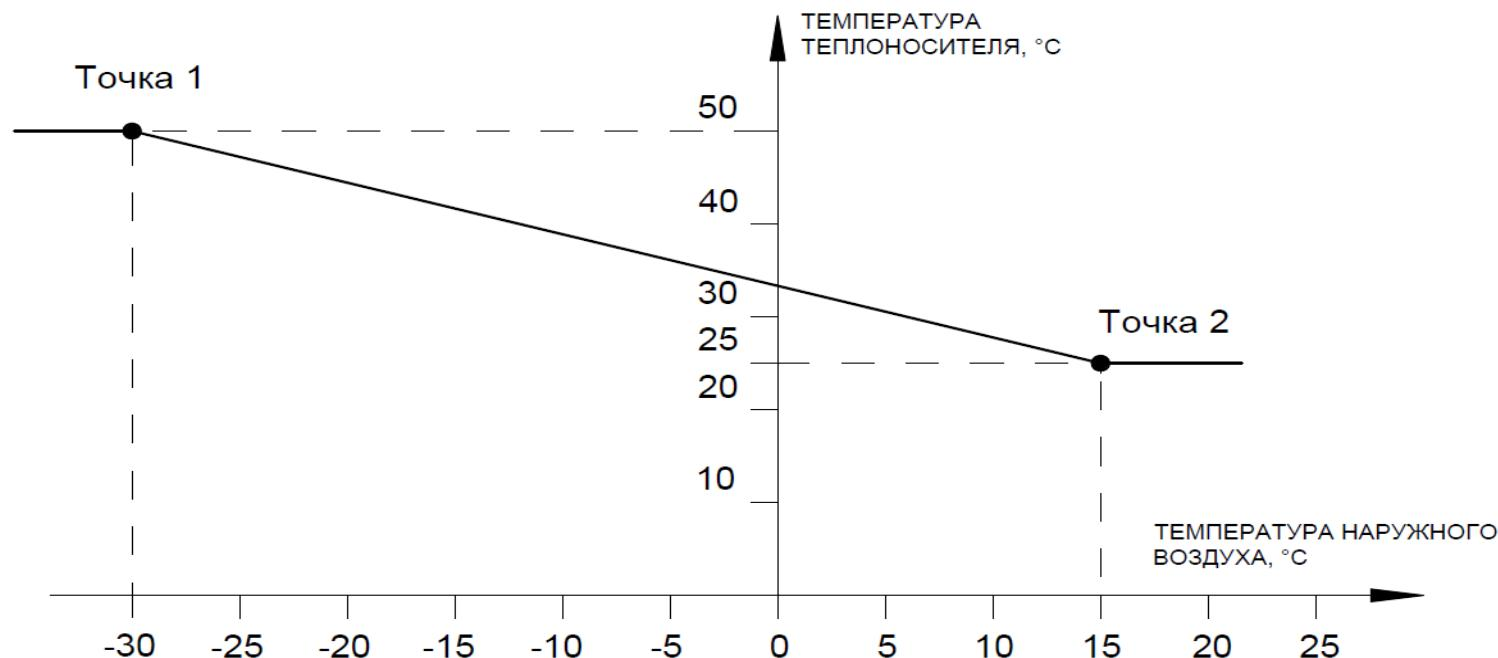
8.3.1. *Заводские настройки графика:* график задан двумя точками: «U1 -30°C, Y1 +50°C; U2 +15°C, Y2 +25°C».
