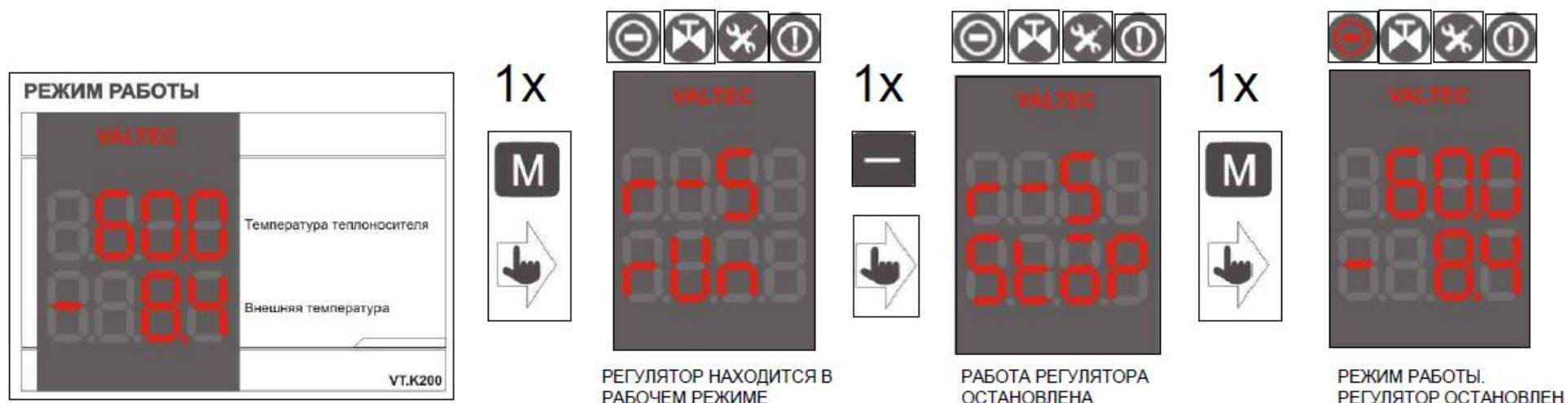
Для перевода регулятора в режим «Остановка регулирования» необходимо кратковременно нажать клавишу **M**, затем произвести переключение однократным нажатием клавиши **-** на экране в нижней строке появится надпись «**StoP**» и загорится знак **—**. Возврат к основному экрану производится кратковременным нажатием клавиши **M**.
