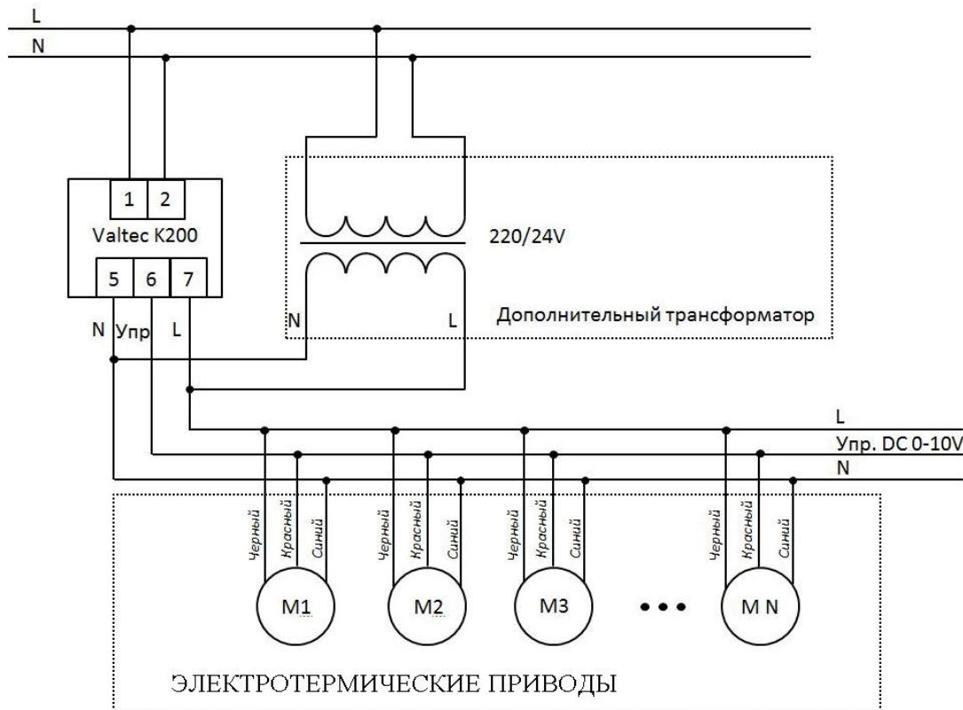
Трансформатор должен обладать выходным напряжением 24В (соблюдать полярность).
