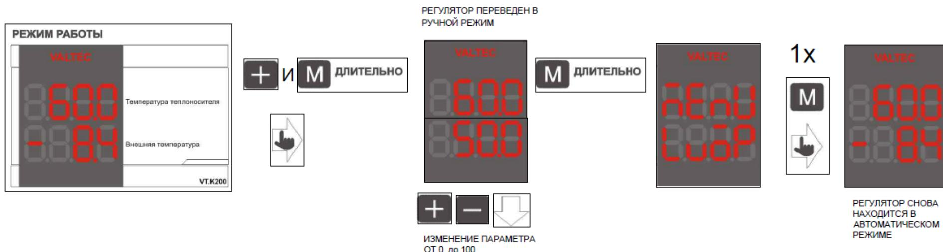
Для перехода в режим ручного регулирования необходимо одновременно нажать клавиши **+** и **M** и держать в течение трёх секунд.
