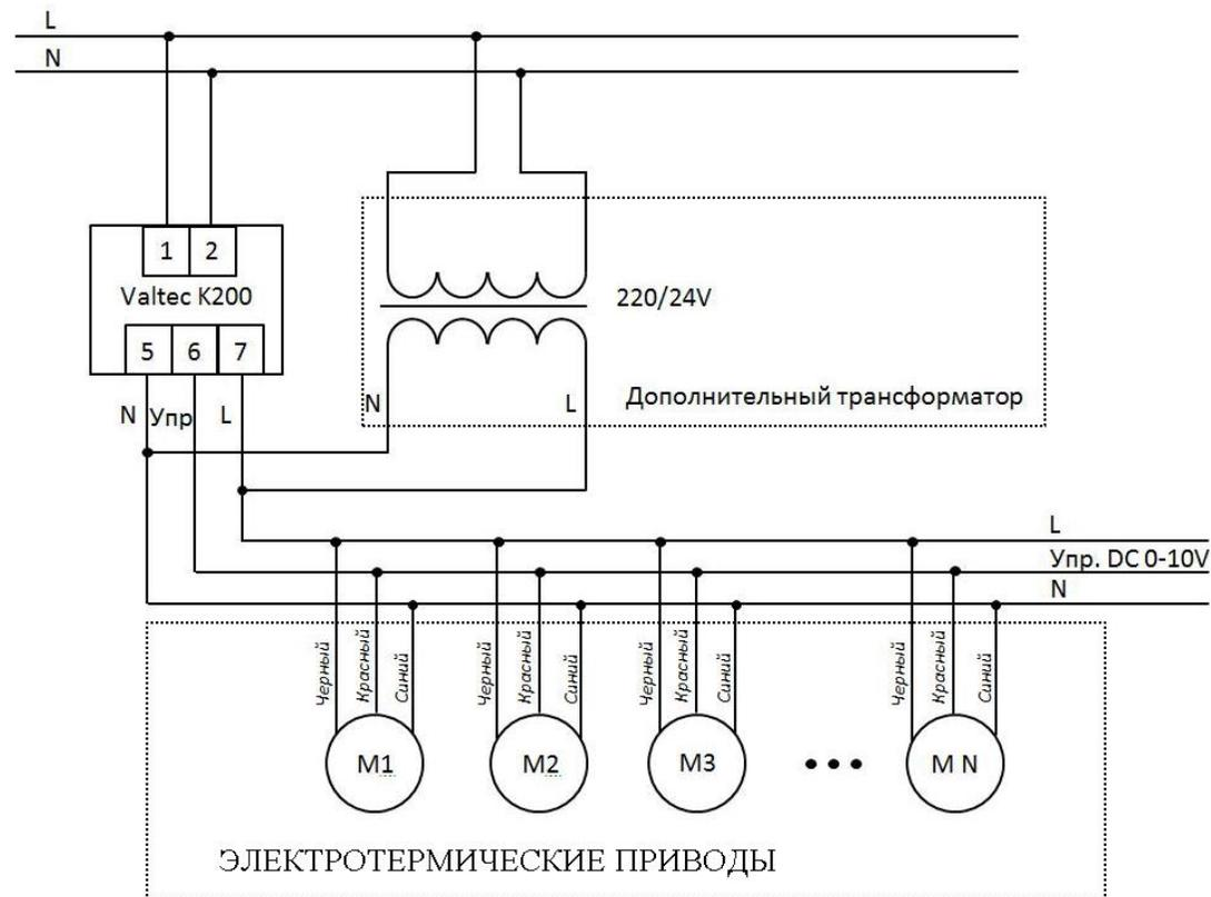
Трансформатор должен обладать выходным напряжением 24В, входным 220В (соблюдать полярность). Трансформатор должен быть подключен к тем же проводам питания АС 220 В, что и контроллер *VT.K200. M*. Выход трансформатора подключается параллельно выходам питания контроллера (клеммы 5 и 7).
