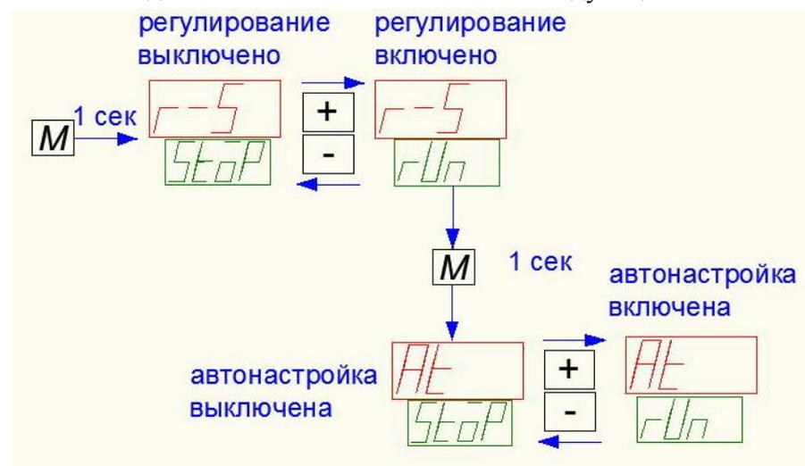
9.5. При выходе на режим автонастройки индикатор «**АВТОНАСТРОЙКА**» загорится и, в случае успешной настройки, погаснет. Если индикатор начнет мигать, необходимо отключить прибор и заново проделать операции.
