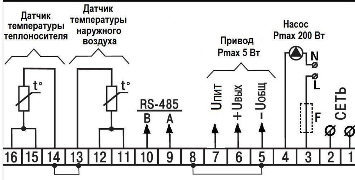
5.3.9. Подключение привода *VT.TE 3061* осуществляется в следующем порядке: клемма 7 –чёрный провод; 6 –красный провод; 5 – синий провод.
