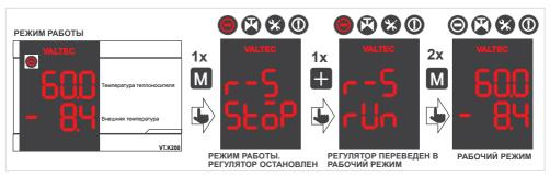
Для перевода регулятора в режим «Пуск регулирования» необходимо кратковременно нажать клавишу м, затем переключить контроллер однократным нажатием клавиши на экране в нижней строке появится надпись «rUn», знак погаснет.
