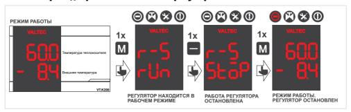
Для перевода регулятора в режим «Остановка регулирования» необходимо кратковременно нажать клавишу м, затем произвести переключение однократным нажатием клавиши на экране в нижней строке появится надпись «StoP» и загорится знак . Возврат к основному экрану производится кратковременным нажатием клавиши м.
