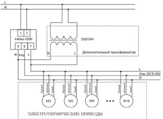
Трансформатор должен обладать выходным напряжением 24В (соблюдать полярность). Трансформатор должен быть подключен к тем же проводам питания АС 220В, что и контроллер **VT.K200.М.** Выход трансформатора подключается параллельно выходам питания контроллера (клеммы 5 и 7).
