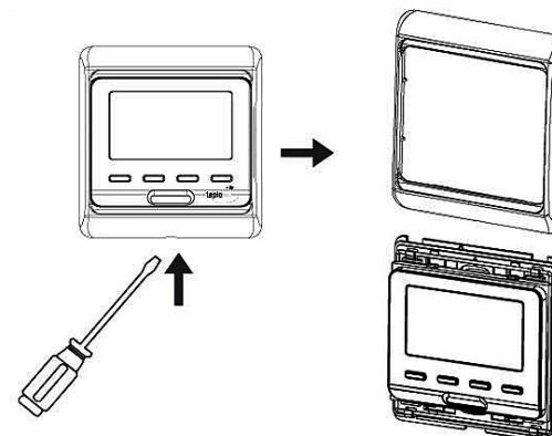
7.2.2. Передвинув вверх проволочную рамку, снимите нижнюю крепежную пластину
