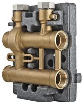
К коллекторному модулю VAR 30 системы VARIMIX присоединяются насосные и насосно-смесительные модули отопительных контуров (VAR 10,11,20,21,22). К каждому модулю присоединяется один отопительный контур. Коллекторные модули могут объединяться в последовательные блоки с помощью соединителей VT. 606.
