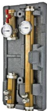
Модуль предназначен для присоединения высокотемпературного контура системы водяного отопления к коллекторному модулю VAR30. Таким контуром может быть радиаторный контур с температурой теплоносителя равной температуре на выходе теплогенератора, или контур бойлера. Модуль снабжен теплоизоляцией из пенополистирола и средствами крепления.
