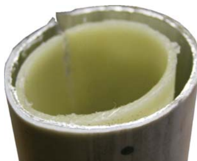
Разрушение трубы при некачественном клее (разрыв при 68 бар)
