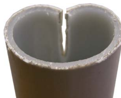
Разрушение трубы при качественном клее (разрыв при 92 бар)
