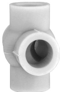
Компланарная полипропиленовая крестовина ВТр.755 позволяет при монтаже выполнять пересечение полипропиленовых трубопроводов, лежащих в одной плоскости, без применения дополнительных фасонных деталей. Это, во-первых, сокращает время и стоимость монтажа, во-вторых, освобождает рабочее пространство, которое занимал бы отвод, и в-третьих, такое соединение смотрится гораздо эстетичнее всех прочих вариантов.
