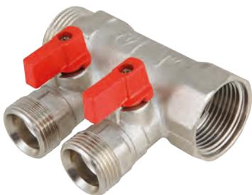
Коллекторы VTr.580N присутствуют в каталоге VALTEC уже достаточно длительный период. Эти коллекторы имеют отсекающие шаровые краны и резьбовые выходные патрубки с наружной резьбой G1/2" (стандарта «евроконус»). Для подключения трубопроводов из различных материалов к данному коллектору используются следующие марки соединителей:
