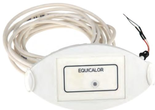
Система дистанционного радиоуправления сервоприводами термостатических клапанов VALTEC EQUICALOR пользуется большой популярностью у потребителей. Напомним, что эта система состоит из хронотермостата с недельным программированием (VT.DC1000), который, с помощью радиосигнала, может управлять до 28 радиосервоприводами (VT.AS1000), установленными на термостатических клапанах отопительных приборов.
