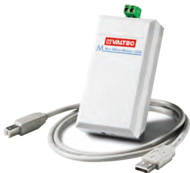
С помощью преобразователя VT.Mini-Master производится конфигурирование счетчиков импульсов через USB-порт (программное обеспечение «MBCONF»). Кроме того посредством преобразователя VT.Mini-Master можно создавать небольшие системы диспетчеризации прямым подключением M-Bus сети из 32 устройств к USB-порту компьютера (в качестве мобильного мастера может использоваться ноутбук).
