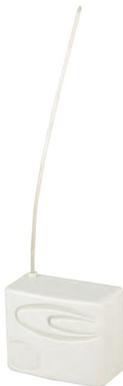
Преобразователь импульсов служит для преобразования импульсов в показания потребления конкретного ресурса в единицах заданных физических величин и передачи данных по радиоканалу на концентратор. Одно устройство выполняет функции и преобразователя импульсов, и ретранслятора радиосигнала. Это позволяет строить ячеистые сети на основе одного типа модулей, максимально распределенные и устойчивые к выходу из строя одного или нескольких элементов цепи.
