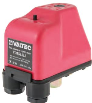
Реле защиты от сухого хода предназначено для защиты электронасосов водоснабжения от работы при снижении давления воды ниже установленного настроечного значения. Значительное падение давления в системе, как правило, вызвано отсутствием воды в трубопроводах. В таких условиях («сухой» ход) электронасосы перегреваются и быстро выходят из строя.
