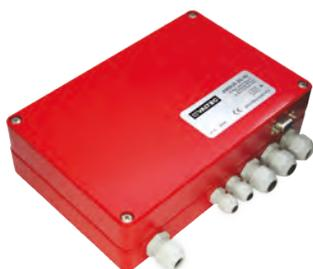
Предназначение репитера VT.AMBUS®ZS состоит в расширении возможностей концентратора AMBUS®Net. Каждое из таких устройств может являться мастером для кластера из 250-ти M-Bus устройств и соединяться с концентратором по протоколу M-Bus repeater, увеличивая размер системы АСКУЭ до неограниченного числа адресов.
