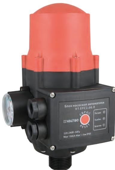
Электронный блок насосной автоматики предназначен для автоматического управления насосами систем водоснабжения, предохраняя их от работы «на закрытую задвижку» и от «сухого» хода. Использование блока автоматики продлевает срок службы насосного оборудования.
